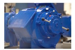
Die JS-Lösung ermöglichte außerdem einen gleichmäßigeren Durchfluss, einen niedrigeren Druck und einen geringeren Verschleiß der Rohrleitung. Die JS Lamellenpumpe ist deutlich geräuschärmer und benötigt im Vergleich zur Kolbenpumpe wenig Platz.
